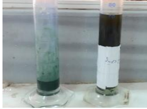
الشكل 4-16 مقارنة الوقود السائل المتكاثف في حالة استخدام حفاز و بدونه
