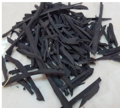
الشكل 4-33 شرائح المطاط المستخدمة في تجربة التحلل الحراري.
