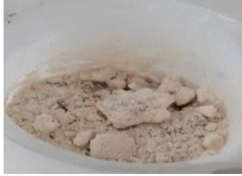
الشكل 4-8 الأكاسيد المعدنية الناتجة عن عملية التحلل الحراري للبلاستيك
