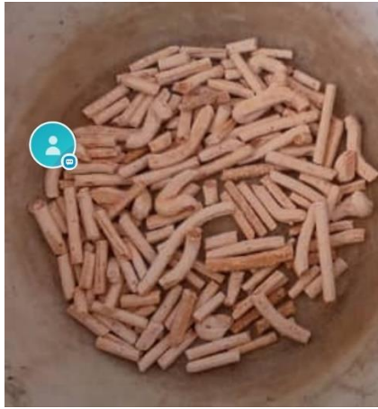
الشكل 4-30 الحفاز الصلب (خامس أكسيد الفناديوم المحمل على الكاؤولين المشوي)
