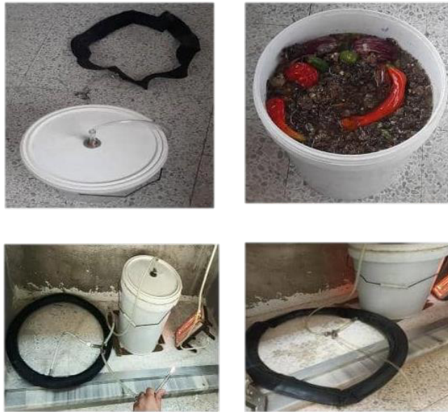
الشكل 5-2 وحدة إنتاج الغاز الحيوي
